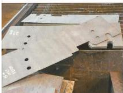
Drobne elementy z blachy pancernej po wycięciu niezbędnych otworów na wypalarni plazmowej.
