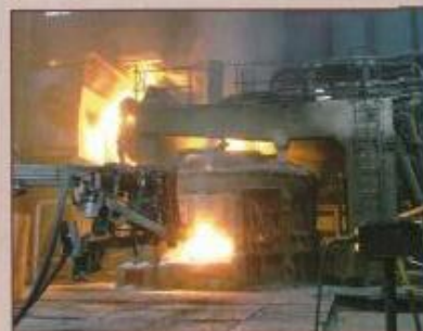
W łukowym piecu elektrycznym żelazo stopiane jest do postaci płynnej.
