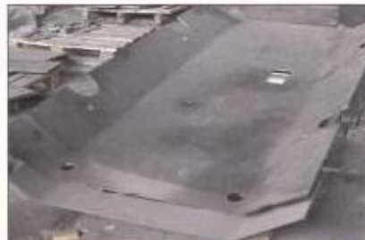
Gotowe elementy podłogi transportera wykonane z blachy PM450.
