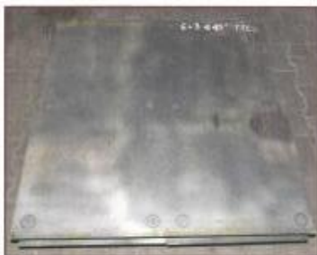
Układ blach 6 i 8 mm (30PM) po ostrzale pociskiem przeciwpancernym 832 amunicji 14,5 mmx114. Kąt nachylenia układu wynosił 45°. Widok od strony wlotu pocisku (górne zdjęcie) i tylnej strony układu (zdjęcie dolne).
