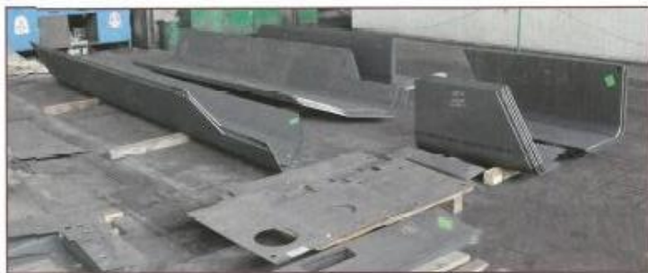
Gotowe elementy kadłuba Rosomaka z blachy pancernej 30PM czekające na ekspedycję do WZM S.A.
