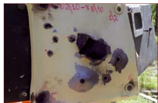
↑ Dodatkowe panele pancerza wieży Rosomaka opracowane przez firmę Mikanit. Ich zastosowanie powoduje zmniejszenie masy pancerza i zapewnia ochronę pancerza zasadniczego przed przebiciem.
