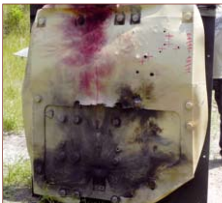
↑ Kasetka po zdetonowaniu głowicy granatu – nie doszło do przebicia pancerza zasadniczego. Na kasecie zdetonowano dwie głowice (na zdjęciu – kasetka po pierwszej detonacji), a następnie...
