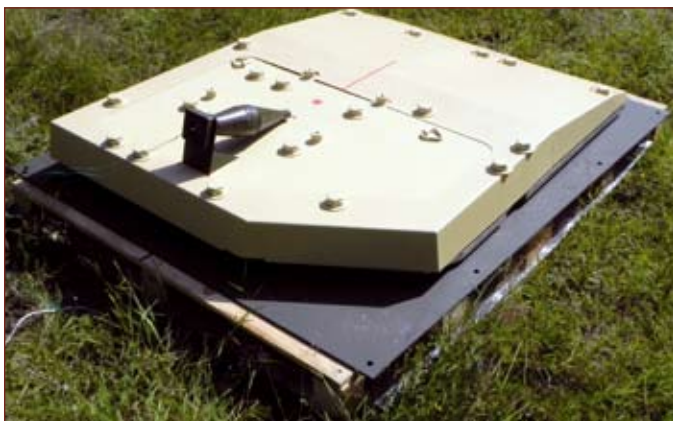
↑ Kasetka przygotowana do próby. Podstawka głowicy granatu uwzględnia kąt nachylenia przedniego pancerza Rosomaka – pod zbliżonym kątem trafi weń granat wystrzelony równoległe do poziomu gruntu.
