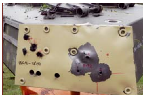
↑ Dodatkowe panele pancerza wieży Rosomaka opracowane przez firmę Mikanit. Ich zastosowanie powoduje zmniejszenie masy pancerza i zapewnia ochronę pancerza zasadniczego przed przebiciem.
