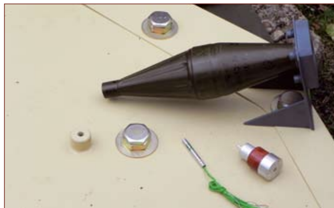
↑ Kasetka przygotowana do próby. Podstawka głowicy granatu uwzględnia kąt nachylenia przedniego pancerza Rosomaka – pod zbliżonym kątem trafi weń granat wystrzelony równoległe do poziomu gruntu.
